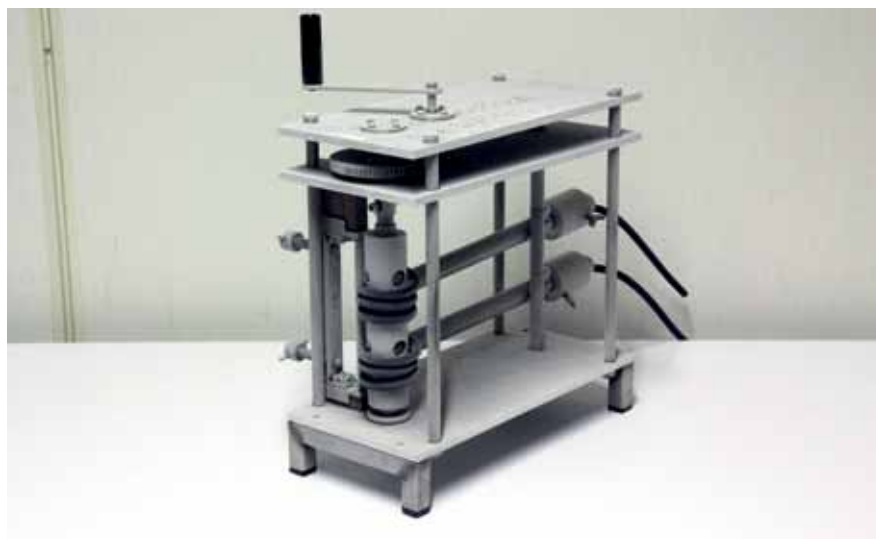
Ylemmässä kuvassa kaapelin taivutustesti käynnissä -35 ° pakkasessa. Alemmassa kuvassa testilaitte palautumassa normaaliin huonelämpötilaan taivutustestin jälkeen.
