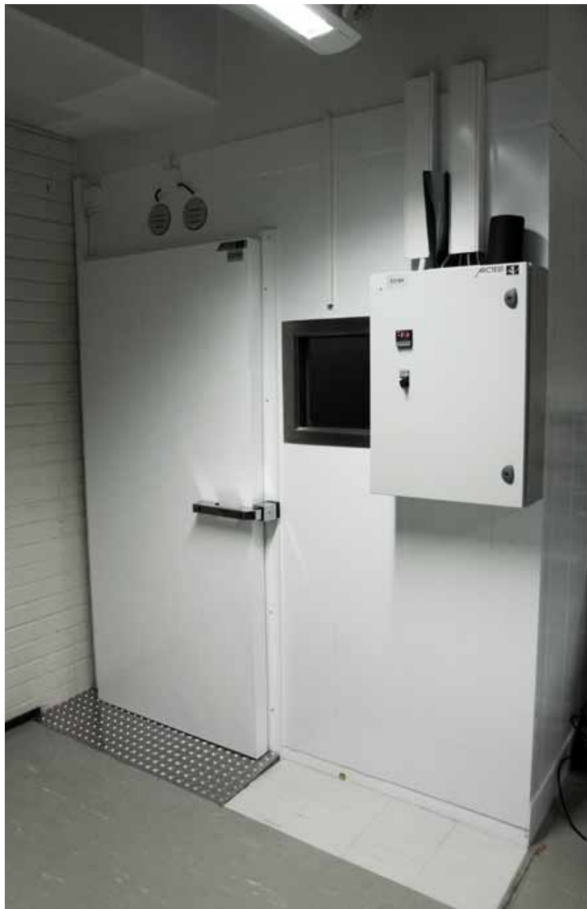
Pakkastestihuone on tilavuudeltaan noin 12m 3 ja huoneen käyttöalue on -15 C° ja -55 C° välillä.
